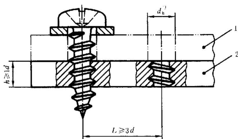
1—垫板(长螺钉用);2 带预制螺纹孔的垫板
