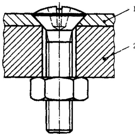
1—带沉孔的上压板;2—下压板
