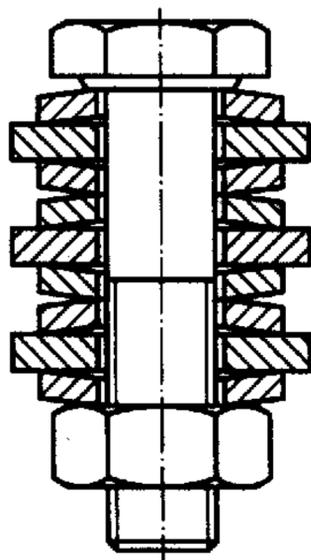
图4 锥形弹性垫圈的试验夹具
