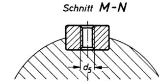
Form F geradstirnig mit Bohrungen für 2 Halteschrauben 3)
