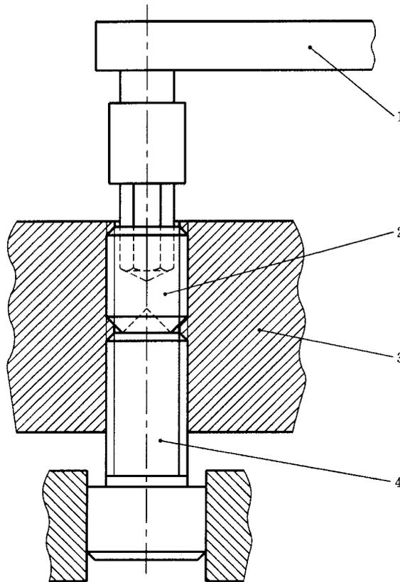
1—扭矩扳手;2—试验螺钉;3—试验夹具:硬度 $\geq 50\text{HRC}$ ;内螺纹公差 5H;
